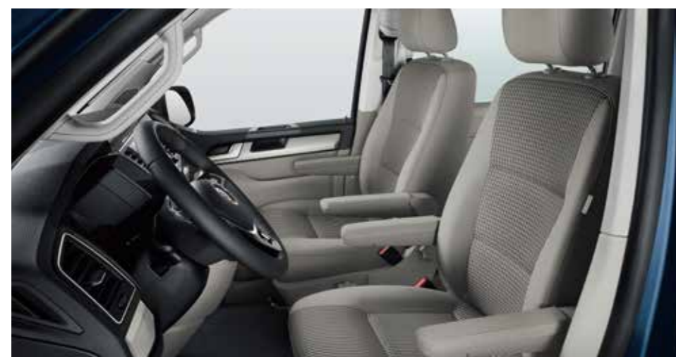
具有腰部支撐的旋轉座椅 駕駛座及前乘客座的人體工學座椅配有扶手與腰部支撐。這些座椅能提供良好的側向支撐並且能旋轉約180°。
