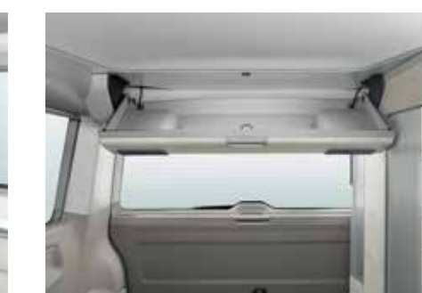
車頂置物盒 在長條座椅的椅背上方設有向下開啟式的置物盒，不論坐著或站著都可輕鬆操作，並設有內建的起居室音響喇叭。
