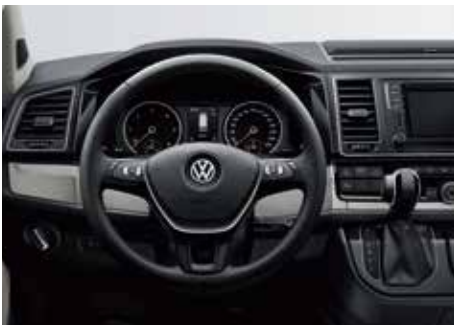
真皮包覆多功能方向盤 具有良好的抓握感，操作上非常便利。音響、手機或定速巡航控制系統皆可利用按鈕進行控制。它具有高度及深度調整功能，能讓駕駛坐得舒適，長途旅程也倍感輕鬆。
