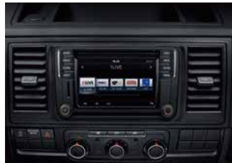
「Composition Media」音響系統 系統包含一個16.5公分(6.33吋)TFT彩色顯示幕、配備電容式觸控螢幕、一台MP3和WMA相容光碟機、六個4x20瓦輸出功率的揚聲器、一個SD卡插槽、一個AUX-IN介面和一個USB連接埠(手套箱內)、一個手機專用藍牙連接，以及一個具有相位調變功能並能提供最佳收音機收訊的雙諧調器。
