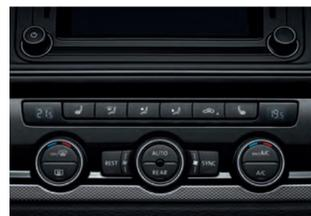
「Climatronic」三區獨立恆溫空調此系統為駕駛、前座乘客、後座乘客提供三區溫度控制。它能辨識陽光強度和車外溫度，進而調整冷卻空氣的強度。自動內氣循環功能與空氣品質感知器能提供舒爽的車內溫度。(4MOTION車款為標配)
