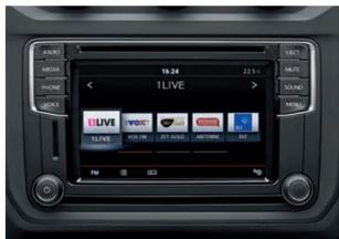
「Composition Media」音響系統系統包含一個16.5公分(6.33吋)TFT彩色顯示幕、配備電容式觸控螢幕、一台MP3和WMA相容光碟機、八個4x20瓦輸出功率的揚聲器、一個SD卡插槽、一個AUX-IN介面和一個USB連接埠、一個手機專用藍牙連接，以及一個具有相位調變功能並能提供最佳收音機收訊的雙諧調器。
