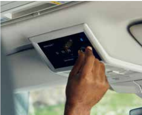
彩色液晶觸控面板 全新的彩色觸控面板位在駕駛艙上方，就連從車頂也可伸手觸控調整。讓駕駛和乘客一目了然的車內多項功能，像是光線、時間、駐車暖氣、電力和車輛顯示角度等設定。
