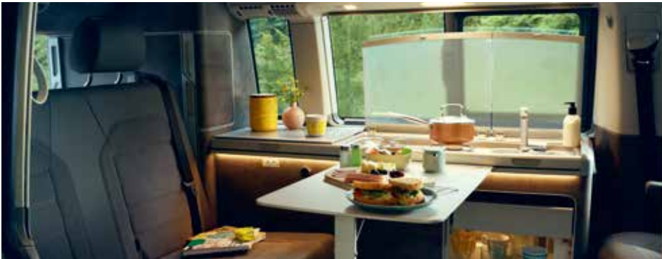
隱藏式摺疊桌 (收納於右側滑門) / 隱藏式折疊椅 (收納於尾門) 隱藏式摺疊桌和2張折疊椅子能當戶外餐桌使用，不用時能巧妙地分別收納至右側滑門和尾門內的隔板中以節省空間。
