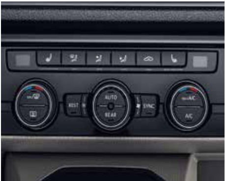
Climatronic三區獨立恆溫空調含 駐車暖氣 此系統為駕駛、前座乘客、後座乘客提供三區溫度控制。它能辨識陽光強度和車外溫度，進而調整空調的強度。在不啟動引擎的狀況下，駐車暖氣也能在寒冬中提供溫暖的車室環境。
