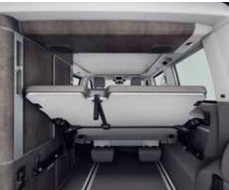
舒適雙人沙發床 乘客艙二人座椅有多段式前後移動的功能，向下摺疊就能打平變成舒適的臥鋪。車尾臥鋪延伸板含多角度調整功能，延伸後臥鋪尺寸達1.14mx1.95m。
