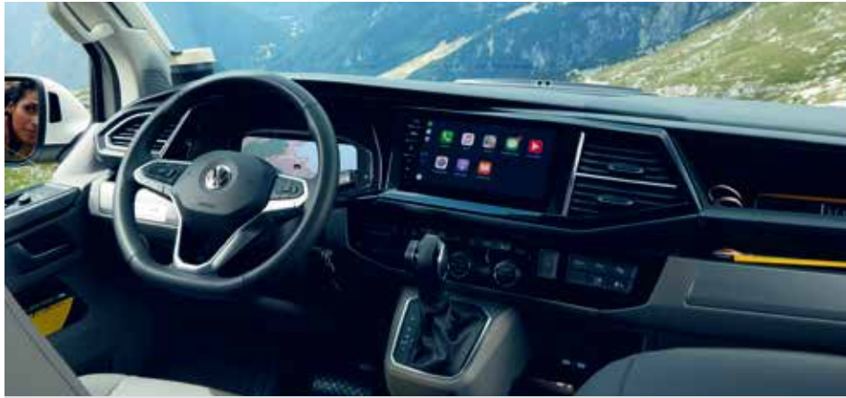
多功能方向盤 / Active Info Display全邏輯數位化儀表板 承襲福斯新世代家族的設計款式，與轎車同等級的 MQB 方向盤，兼顧實用和質感。操作上非常便利，音響、手機或 ACC 等智能駕駛輔助系統皆可利用按鈕進行控制，全車功能一手掌握。搭配 10.25吋 全邏輯數位化儀表板，提供駕駛多項的功能選項，科技化的操作介面，讓駕駛有更直覺便利的數位體驗。
