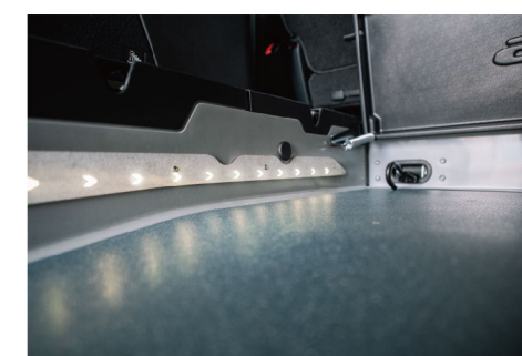
坡道LED燈條裝置設計， 增加輪椅空間照明
