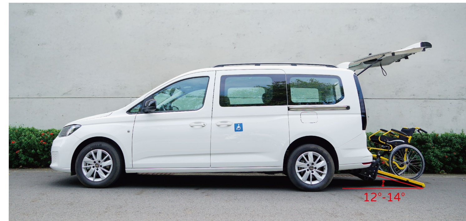
承載重量 300 kg、斜坡道角度 12°-14°、斜坡道長1,100 mm
