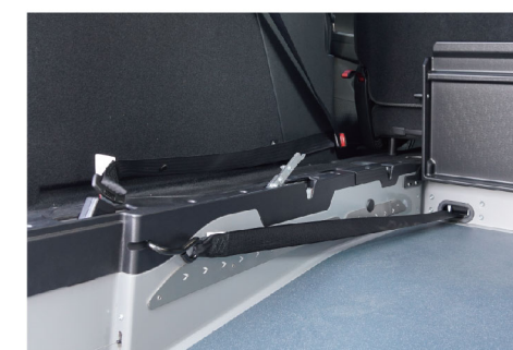
收縮固定帶，防止輪椅進退時滑落
