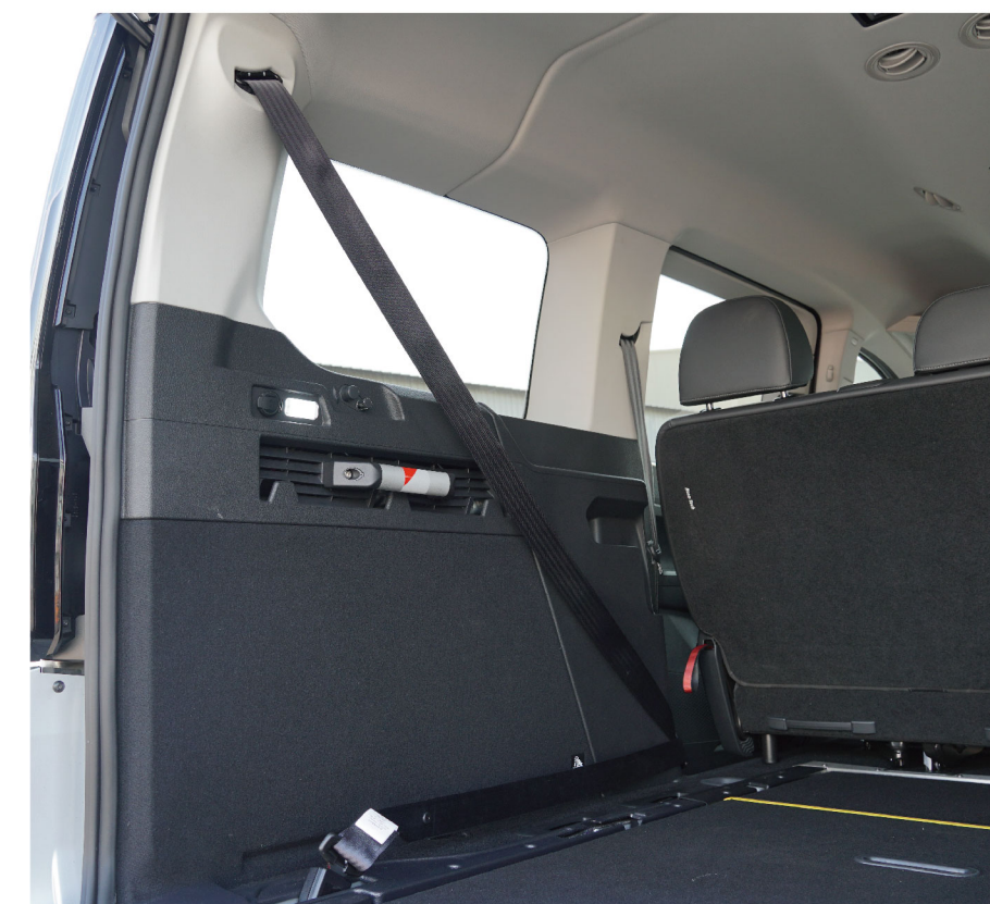
沿用原車安全帶位置，設置輪椅三點式安全帶，保留完美車飾
