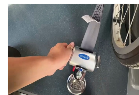
輪椅固定器，雙旋鈕設計， 雙手施力鎖固更安全
