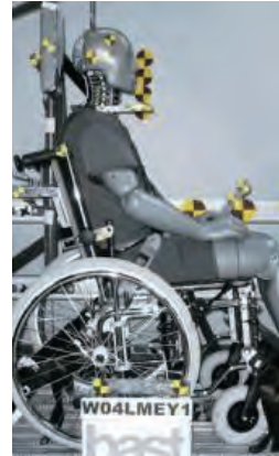
輪椅四點安全束縛系統成為德國標準 DIN 75078
