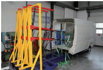
使用自建校準拉力測試設施（配備六個油缸）進行靜態拉力測試。
