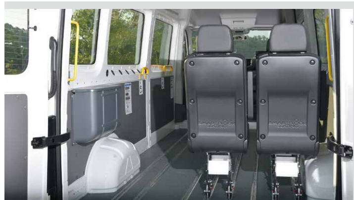
原車配有的Smartfloor系統採用個人化設計，可靈活變化座椅組合讓乘客艙可以單獨運用於日常生活的多樣特定需求。
