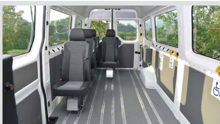
原車配有的Smartfloor系統採用個人化設計，可靈活變化座椅組合讓乘客艙可以單獨運用於日常生活的多樣特定需求。
