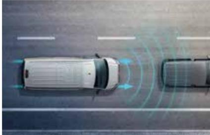
**ACC 主動式車距調節巡航系統<sup>2)3)</sup>**
