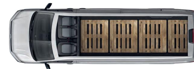
3人座椅配置，長軸後方可容納歐規尺寸1,000x1,200mm棧板4個。
