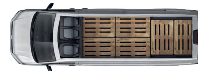
3人座椅配置，長軸後方可容納歐規尺寸800x1,200mm棧板6個。
