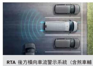
**RTA 後方橫向車流警示系統 (含煞車輔助功能)**
