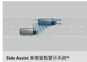
**Side Assist 車側盲點警示系統<sup>4)</sup>**
