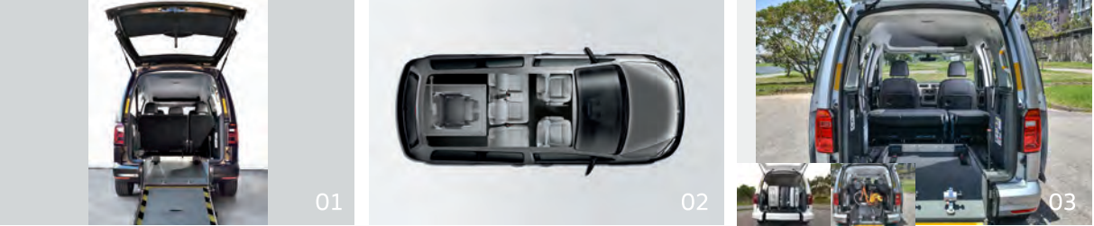
01 德國進口AMF- Bruns獨家設計的輪椅坡道套件,斜坡板伸展後與車室內的輪椅空間呈現平坦坡道 02 6人樂活寬敞空間 03 輕巧車身 百變功能 超過3,880公升的裝載空間
