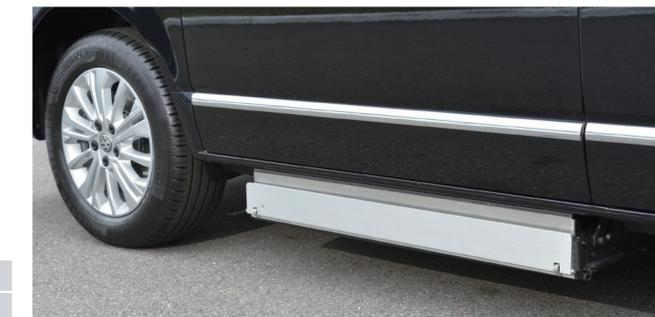
\* 超薄艙匣機體設計，升降機收納於不銹鋼艙匣中，隱密收納，增加距地高度。
