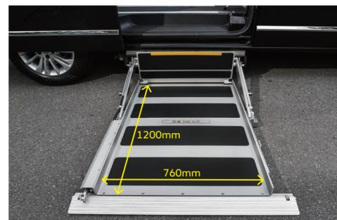
\* 輪椅平台止擋片自動開合及作動時專利鎖定功能確保輪椅乘客安全。
